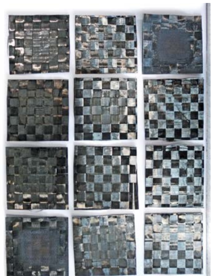
Abb. 2: Zwölf CF-Lagen, durch induktive Erwärmung aus einer 60 x 60 mm CFK-Platte separiert
