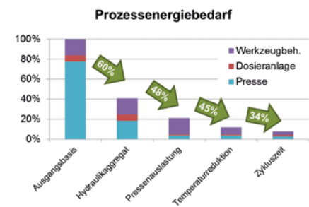
Abb. 2: Energieeffiziente Prozessführung am Beispiel RTM-Prozess
