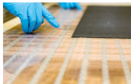
Elektroadhäsive Fixierung von Luftfahrt-Gewebe mittels nachgerüsteter Elektrodenstrukturen
