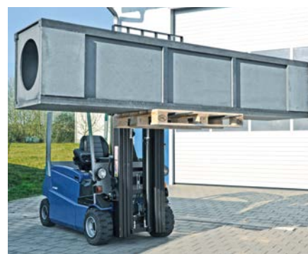
CFK-Grundkörper der y-Achse einer Laserschneidmaschine
