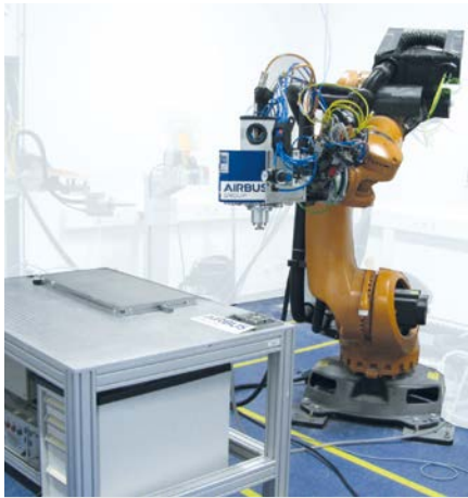
Abb. 4: Mobiles Schweißmodul, auf Roboter montiert
