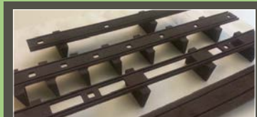
Herstellung von Schaum oder CFRP-Inserts.
