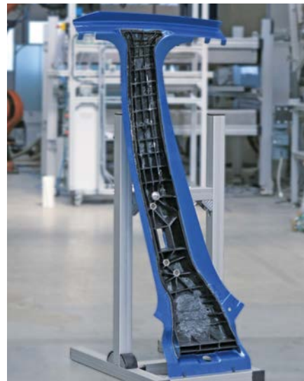
Das Ergebnis einer gelungenen Kooperation: die B-Säule in Multi-Material-Leichtbauweise
