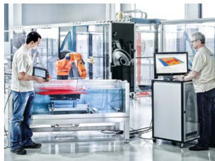
Robotergestützte Ultraschall-Prüfung mit integrierter 3D-Rekonstruktion des Bauteilvolumens
