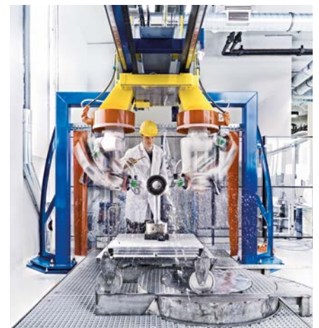
Automatisierte zerstörungsfreie Prüfung: Wasser zum Koppeln und Roboter zum Führen im 3D-Raum. Aber ohne den Menschen geht es auch nicht!
