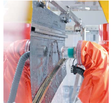
Robotergestützte zerstörungsfreie Prüfung an CFK-Karosserie
