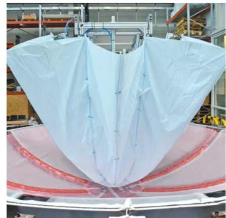
*Alle textilen Materiallagen des VAP®-Aufbaus für die Druckkalotte des A350 wurden im Projekt RoCK in einem VAP®-3D-Kit bauteilorientiert konfektioniert und automatisiert abgelegt.*
